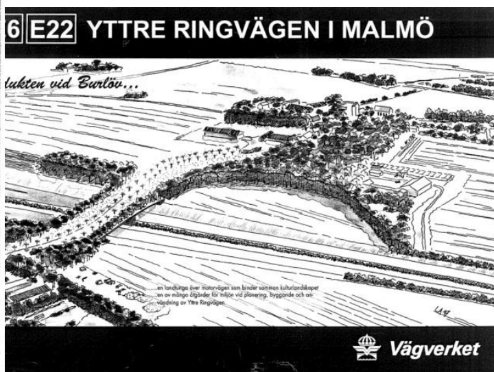
Figur 13. Trafikverkets ekodukt över E6 mellan Burlövs kyrkby och Burlövs egna hem som ersättning för den tidigare historiska vägen till Kronetorps mölla
