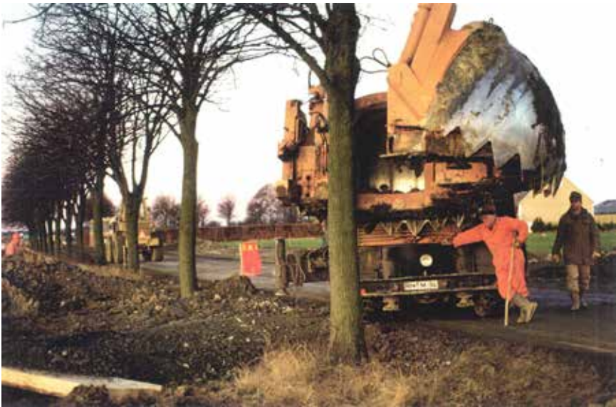
FIGUR 13. Inhyrd maskin för flytt av träd.
